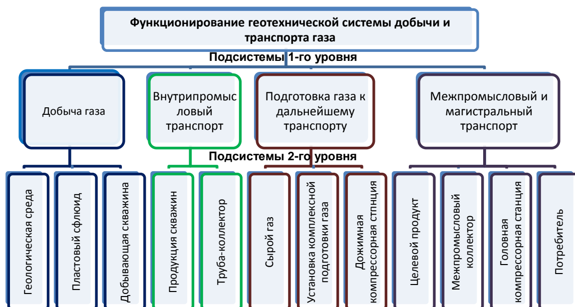
Рисунок 3.17 – Структурирование геотехнической системы добычи газа на функциональные подсистемы (по А.М. Олейнику)
