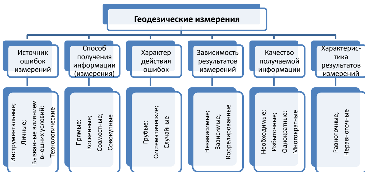
Рисунок 3.12 – Классификация измерений и их ошибок в геодезии (по Г.А. Уставичу)
